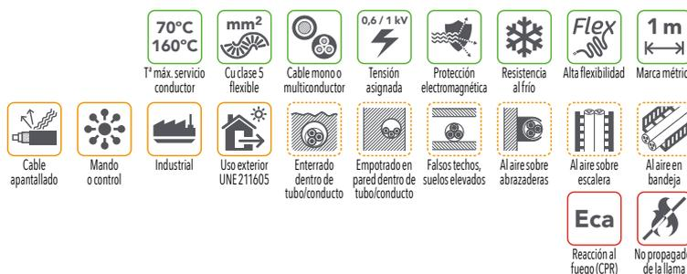
• Normativa (construcción/ensayos): UNE 21123-1 e IEC 60502-1.
